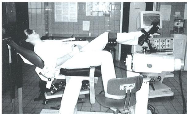
Medidas: Se utiliza un goniómetro electrónico, ya que el estudio se basaba en alcanzar el rango final (15°-20°), pasando por distintas angulaciones, determinantes para valorar la fuerza y un dinamómetro Biodex, para determinar los momentos máximos de fuerza isocinética (Con/Exc, I/E); además de la utilización de un programa de software (Cybex NORM) donde quedan guardados los datos analizados.
